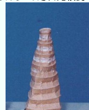
溶接作業場における 防じんマスクのフィルタの汚れ比較例
