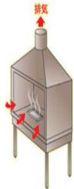
局所排気（囲い式フード）の例
