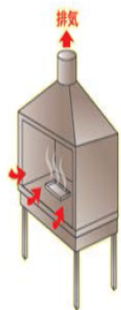
局所排気（囲い式フード）の例
